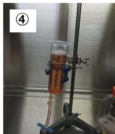
写真4 NKCC- bへの培養液の充填方法
