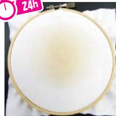
試験片に汚れ種を付着させて約24時間放置する。
