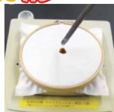
汚れ種が所定の重量となるように、試験片中央部一点に付着させる。
